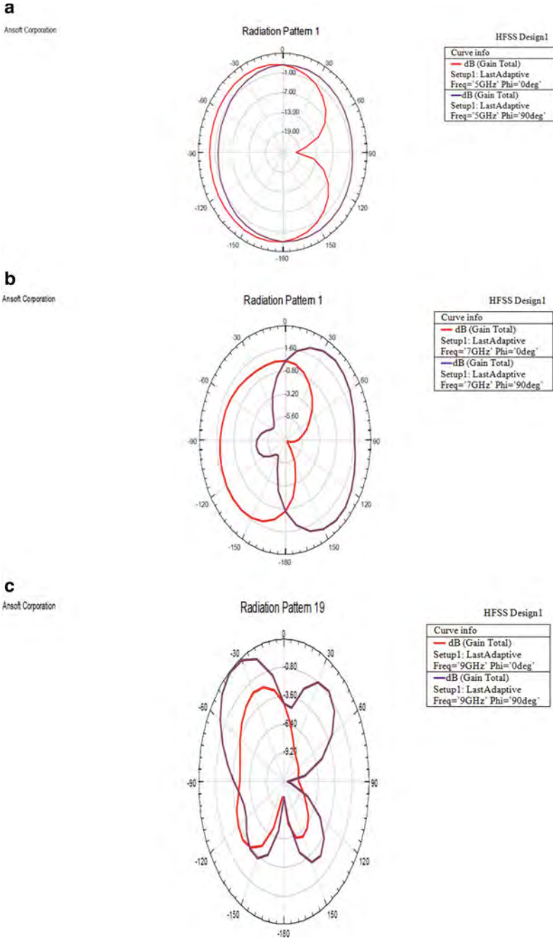
Fig. 4 a 2-D E-plane RP at 5 GHz. b 2-D E-plane RD at 7 GHz. c 2-D E-plane RD at 9 GHz. d 2-D E-plane RD at 12 GHz. e 2-D E-plane RD at 12 GHz
